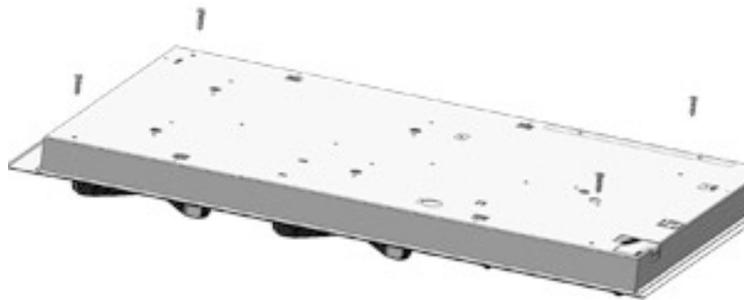
**Attenzione**, non utilizzare avvitatori elettrici o chiavi dinamometriche per il fissaggio del piano. Serrare a mano senza forzare le viti.
